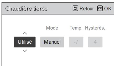
Si le mode de cette fonction est réglé sur « Manuel », vous pouvez régler la température de la chaudière et l'hystérésis, respectivement.
