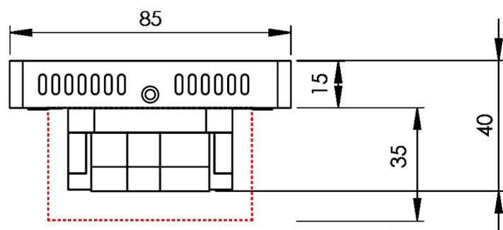
Remarque : compatible avec un boîtier standard de 35 mm d'épaisseur
